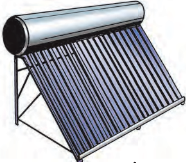
شکل ۹ء۵: شمسی توانائی پر چلنے والا گیزر (گرمالہ)
