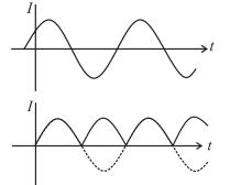
Fig. 12.8: (c) Alternating current, (d) Pulsating direct current.
