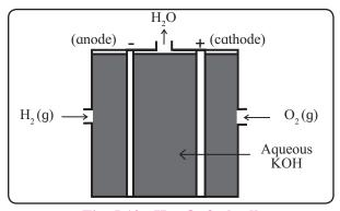
Fig.  $5.10: H_2 - O_2$  fuel cell
